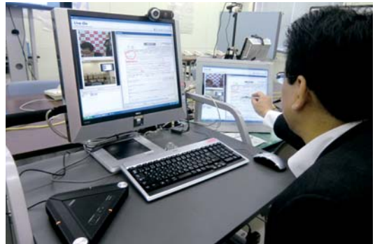
本部に設置されたWeb会議システムとPJP-25UR。セキュリティを確保するためモニター一体型のPCを採用し、WebカメラとPJP-25URを接続するというシンプルな構成となっている。右側のペンタプレットにより、資料への書き込みも共有される。
