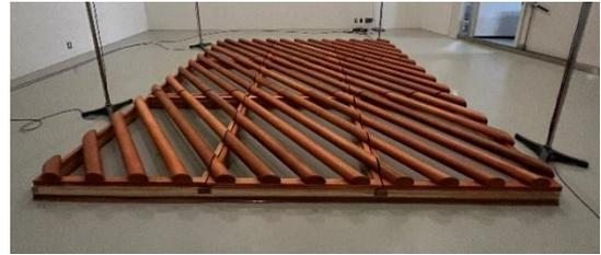
図 9 残響室法吸音率測定風景
